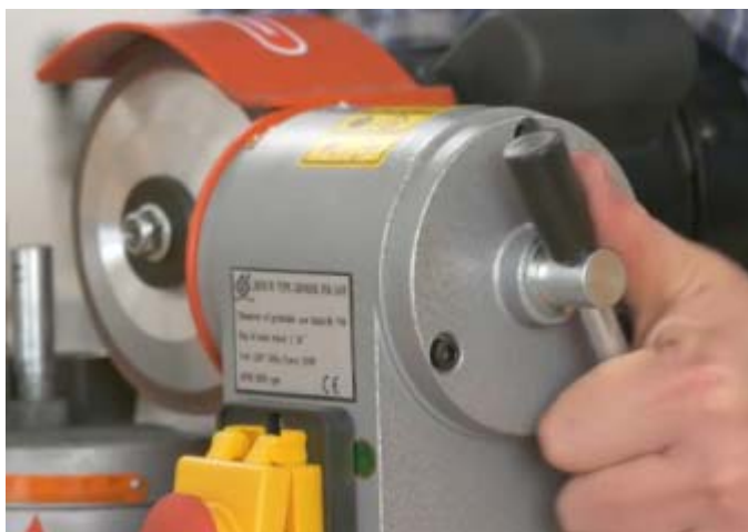
Рис. 20.3 Винтом (18) зафиксируйте положение
