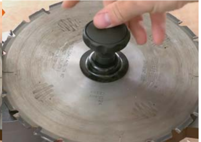
Рис. 15.4 Зафиксируйте пильный диск ручкой винтом (12)
