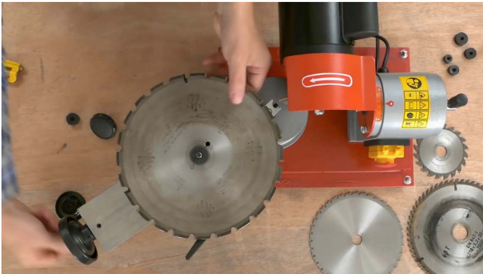
Рис 21.2 Маховиком (8), установите диск в рабочее положение Зафиксируете положение винтом (5)
