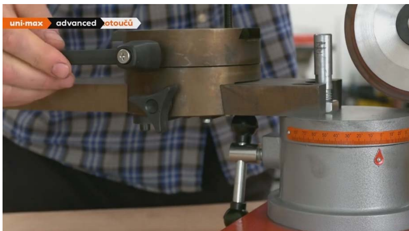
Рис. 12.3 Ослабьте винт (6) Винт суппорта
