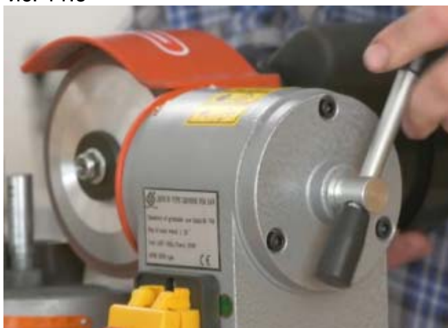
Рис. 11.1 Ослабьте крепеж винта (18)
