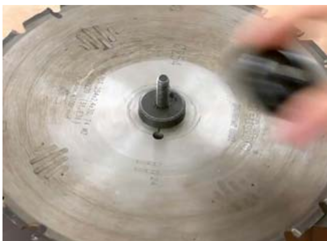
Рис. 15.1 Установите переходную втулку для пильного диска нужного диаметра
