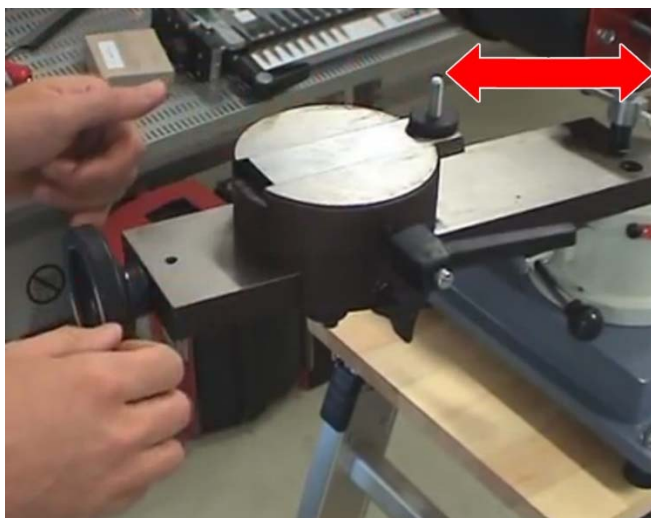
Рис. 6.1. Положение 1 при заточке пильных дисков. Стрелкой указан радиус затачиваемого диска
