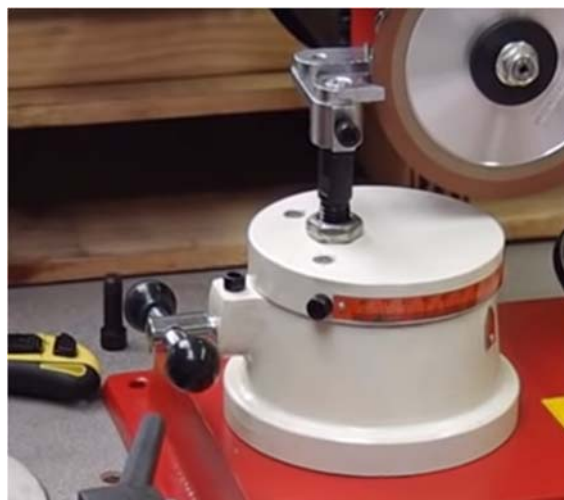
Рис. 3.2. Открутите винты фиксирующие шестигранные
