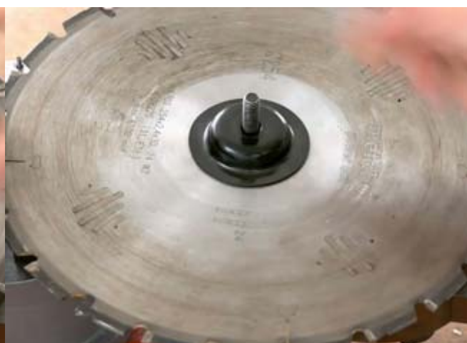
Рис. 15.2 Установите прижимную пластину (11)
