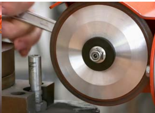
Рис. 8.2 Повернуть диск. Установить в рабочее положение и зажать с помощью гаечного ключа.
