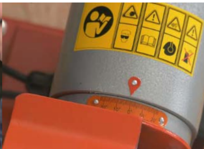
Рис. 11.2 Установите угол наклона 0 град
