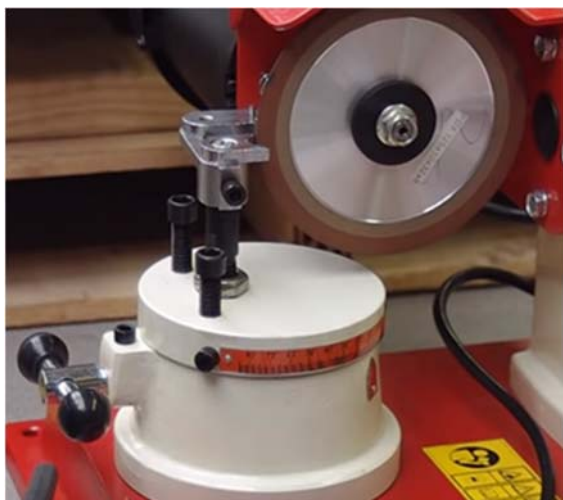
Рис. 3.1. Винты фиксации опоре суппорта
