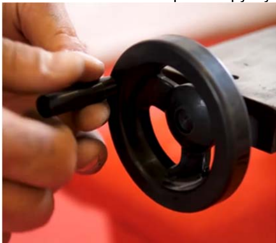
Рис. 4.3. Установите и закрутите ручку в маховик
