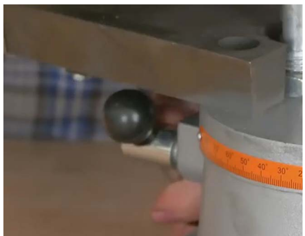
Рис. 16.2 Винт фиксации суппорта (3)
