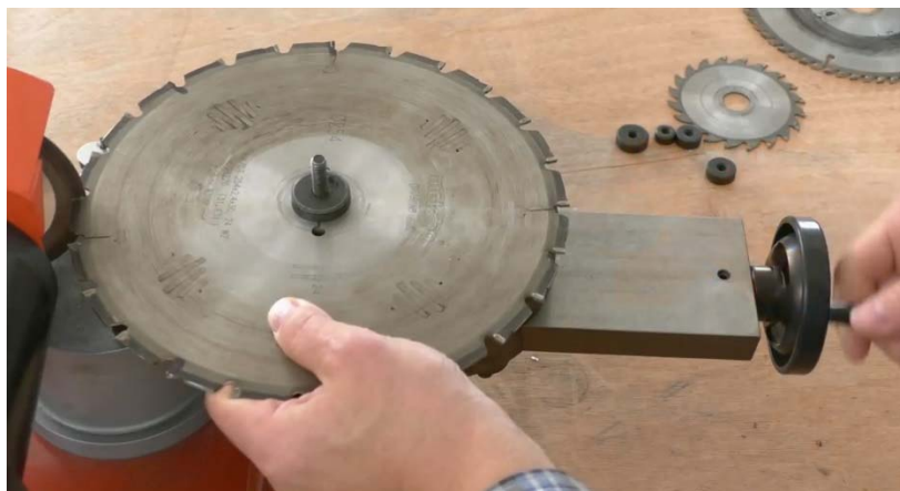
Рис. 13.1 Маховиком (8), установите диск в рабочее положение
