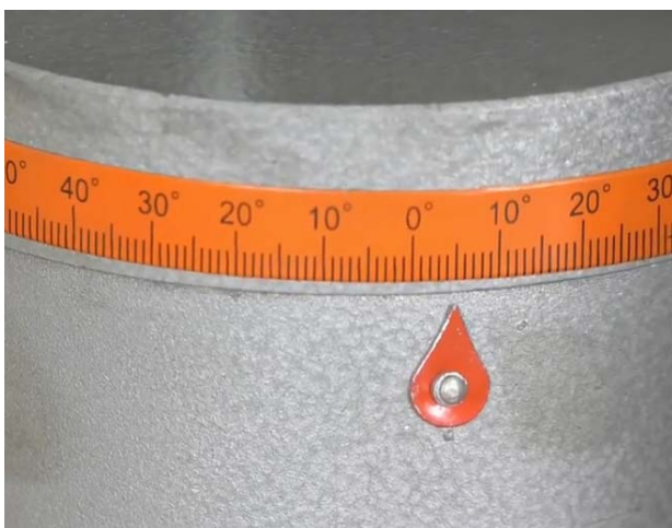
Рис. 16.1 Шкала стойки суппорта
