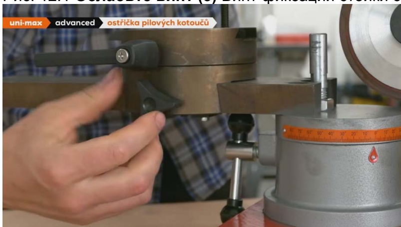
Рис. 12.2 Ослабьте винт (5) Винт фиксации положения ползуна
