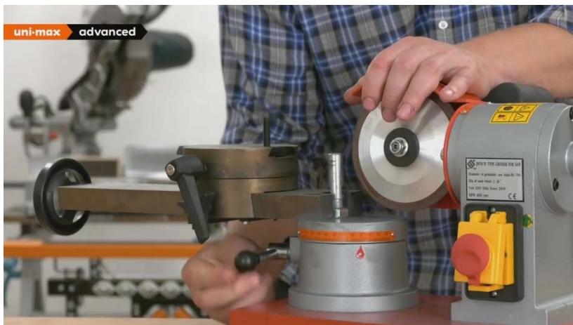
Рис. 12.1 Ослабьте винт (3) Винт фиксации стойки суппорта
