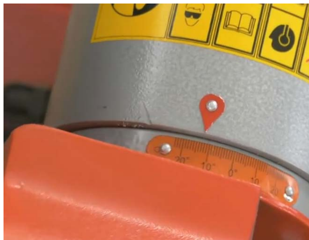
Рис. 20.2 Установите угол наклона
