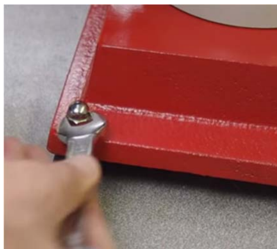
Рис. 5.2. Закрутите с помощью рожкового ключа
