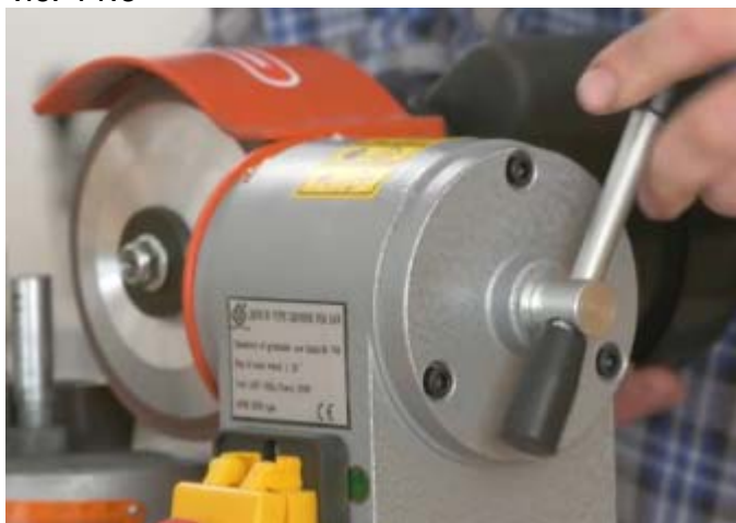
Рис. 20.1 Ослабьте крепеж винта (18)
