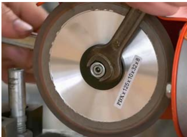
Рис. 8.1 Снять зажимную гайку
