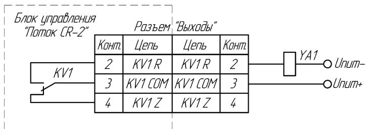
Рисунок 4.14 - Управление шторкой-задвижкой. Схема 2
