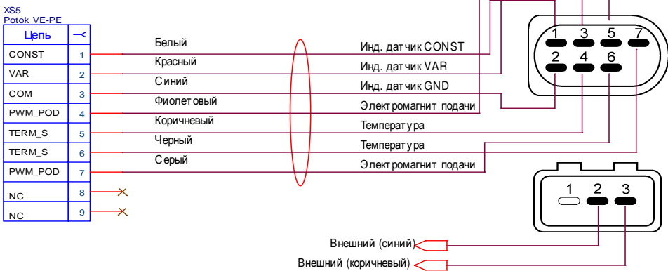
Рисунок 24. Схема распайки разъема ТНВД тип 4
