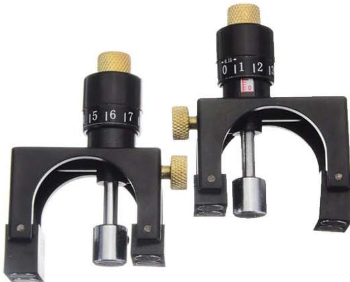
Приспособление ZW71-KA-2 (магнитная система) упрощает операцию установки строгальных ножей в ножевом валу. Приспособление позволяет произвести точную установку строгальных ножей двух сечений вала а наличие фиксирующего винта обеспечит параллельность всех ножей строгальной головки.
